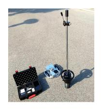
图 1 手持式落锤弯沉仪实物图
