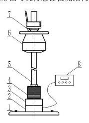
图 2 手持式落锤弯沉仪结构示意图
