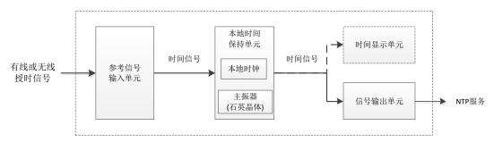
图 1 网络授时终端工作原理示意图
