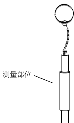
图3 硬度标准棒结构
