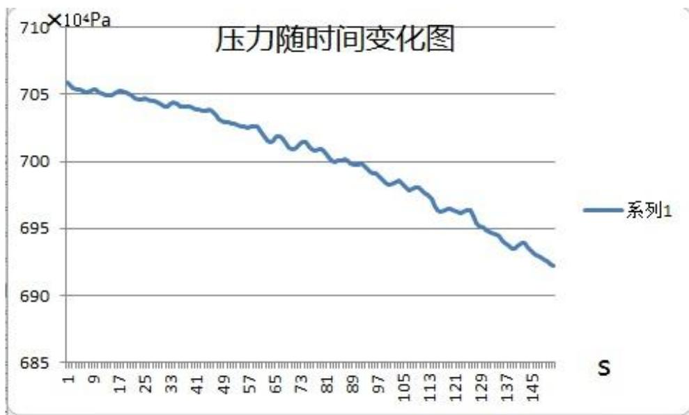
图 6 压力随时间变化图
